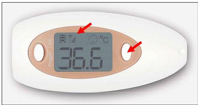
Fig.3 接続ボタンとアンテナマーク
